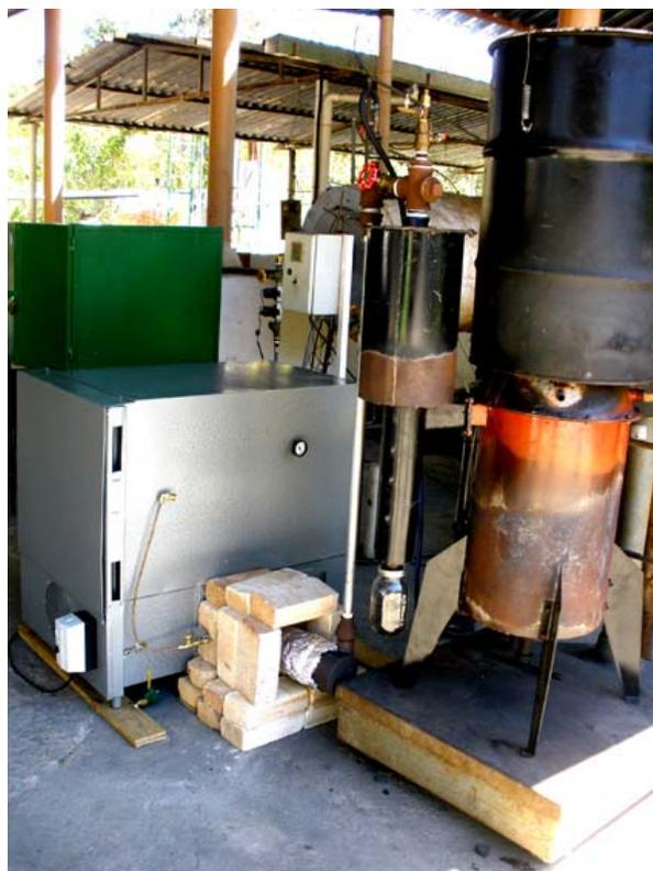
**Figura 11.** Sistema desidratador-gaseificador pronto para utilização
