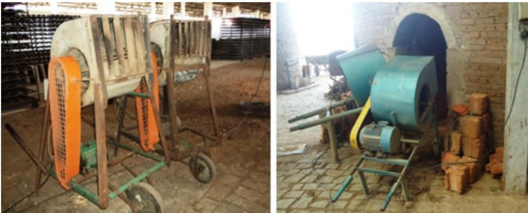
Figura 11. A) Ventoinha utilizada na cerâmica Bela Vista durante a fase de resfriamento dos fornos; e B) Modo de utilização da ventoinha
