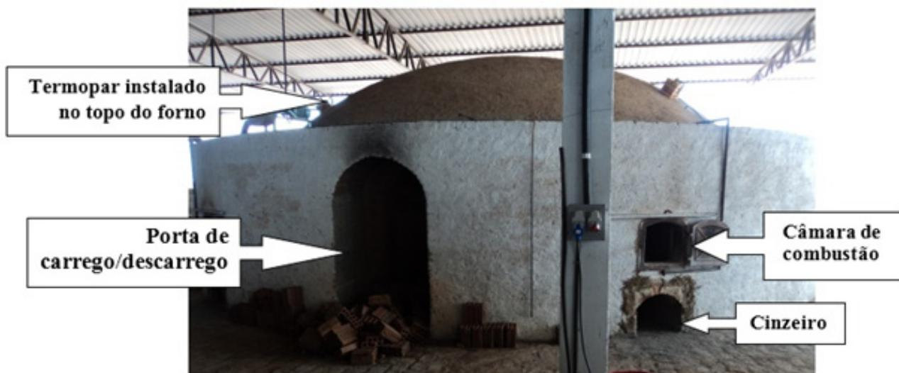
Figura 9. Forno tipo abóboda utilizado para queima dos produtos cerâmicos na Cerâmica Bela Vista no município de Parelhas/RN e especificações das suas principais partes
