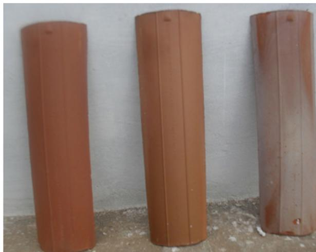
Figura 13. Da esquerda para direita: A) Telha de primeira qualidade; B) Telha de segunda qualidade; C) Telha de terceira qualidade
