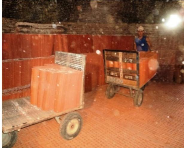
Figura 12. Desenformamento de telhas nos fornos abóboda
