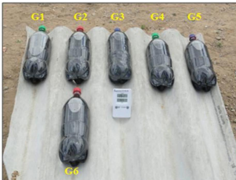
Figura 3. Aplicação da técnica SODIS com garrafas PET (G1, G2, G3, G4, G5 e G6) pintadas de preto na sua metade inferior
