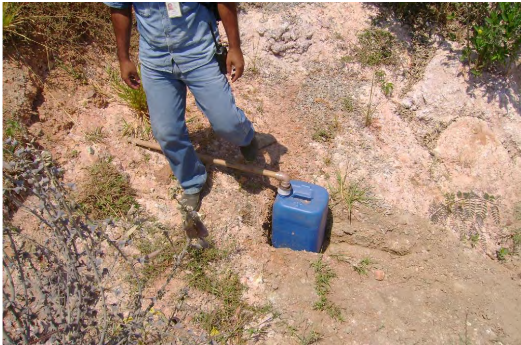
Figura 3.12 - Tubo para coleta da água dos lisímetros e galão coletor para a realização das medidas.
