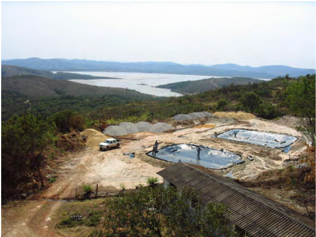
Figura 3.7 - Lisímetros instalados na porção central da área.
