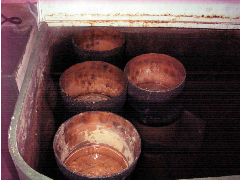
Figura 3.30 - Saturação das amostras para calibração dos equipamentos.
