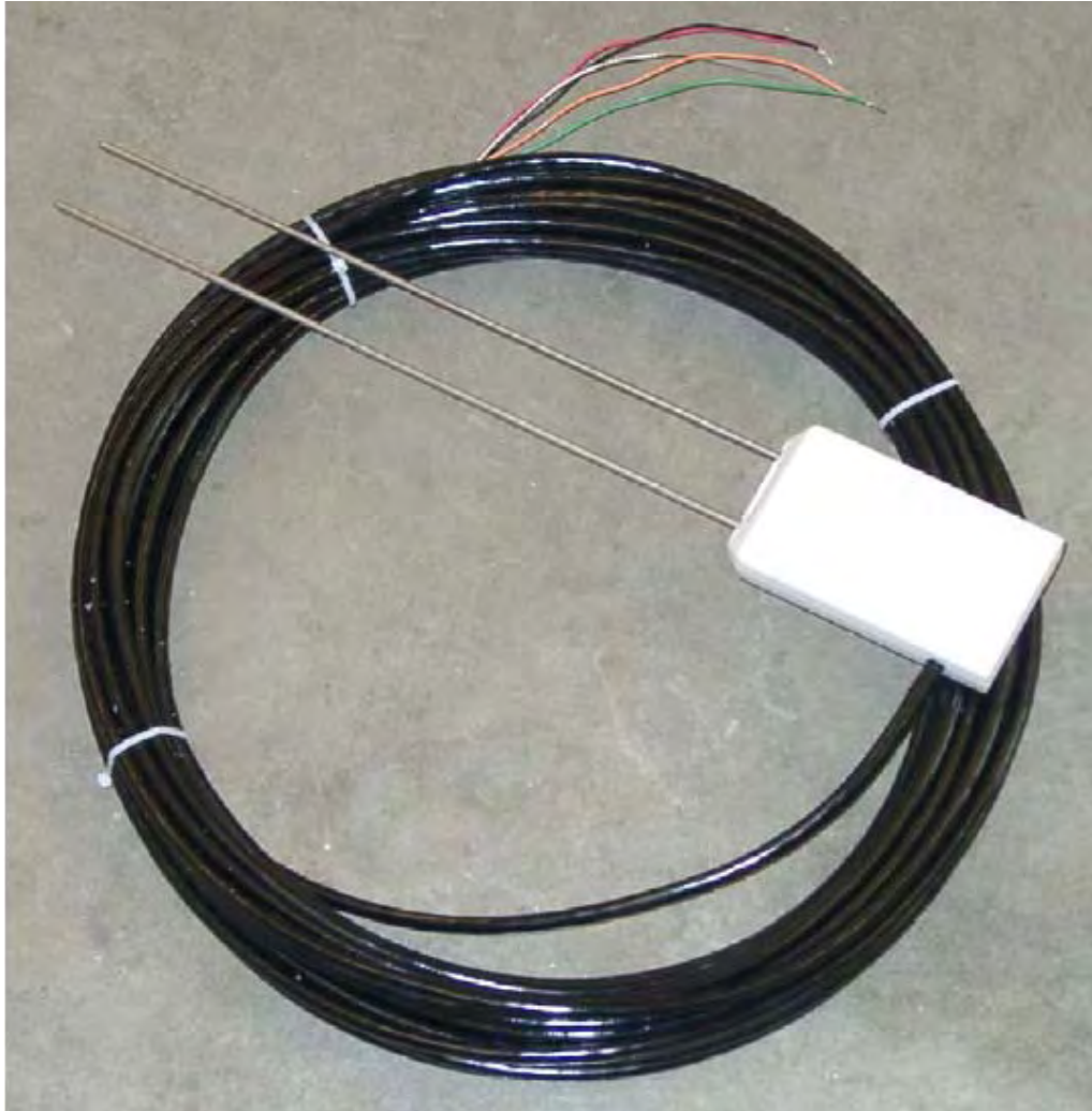
Figura 3.26 - Instrumento para medir umidade em campo - TDR (EPA, 2002).
