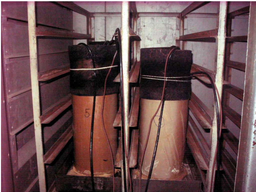
Figura 3.31 - Amostras indeformadas com os TDRs e cabos, dentro da estufa.
