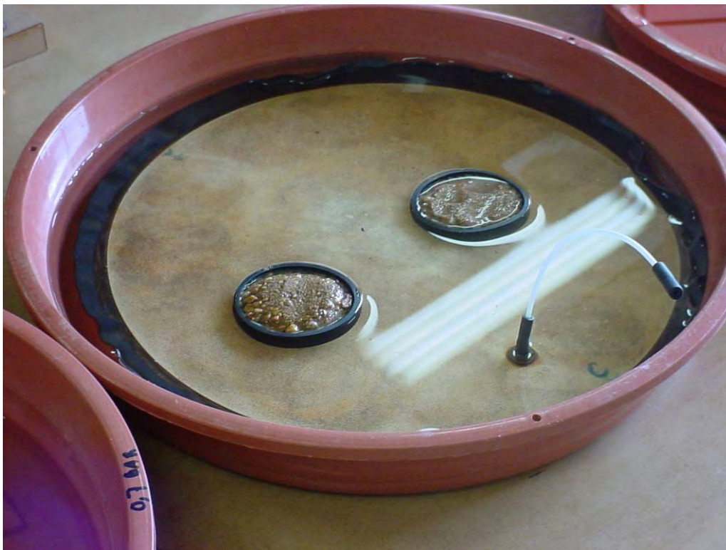
Figura 3.45 - Placa de cerâmica e amostras do solo em processo de saturação durante aproximadamente 12 horas.
