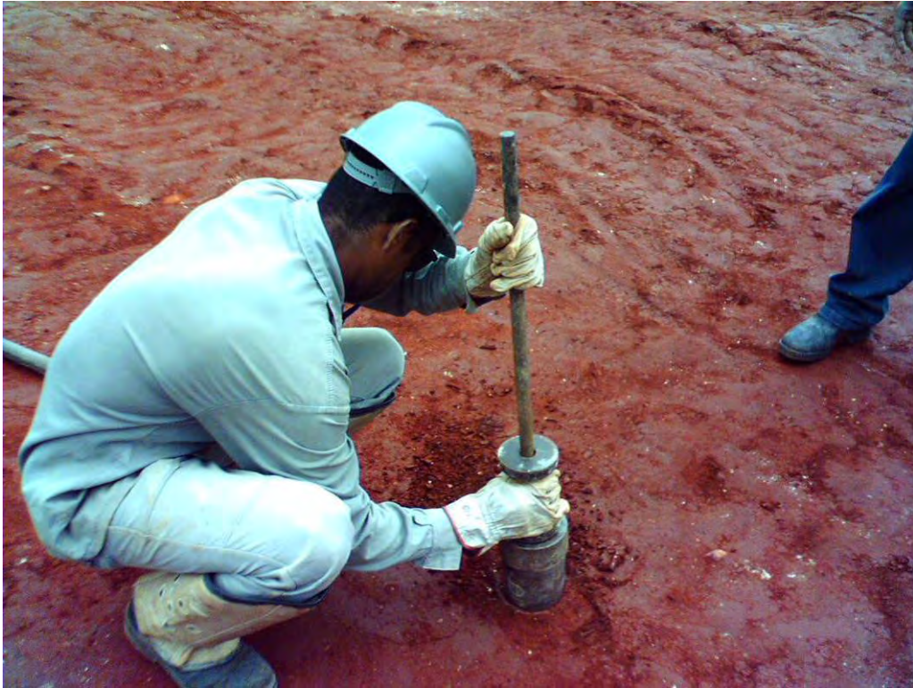
Figura 3.20 - Realização de ensaio para a determinação da densidade in situ com cilindro biselado.
