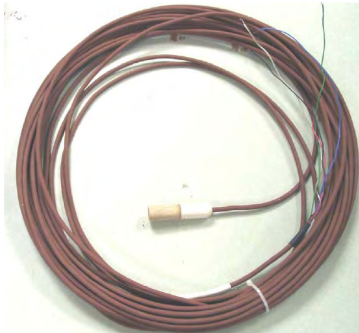
Figura 3.32 - Unidade de dissipação de calor (EPA, 2002).
