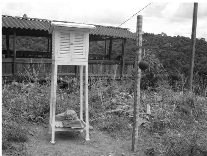
Figura 5 - Abrigo meteorológico com os instrumentos de medição das variáveis climáticas no ambiente externo.
