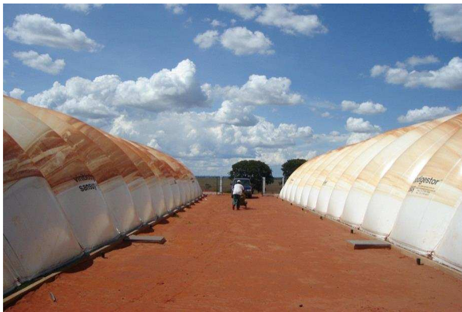
Figura 2. Células de biodigestor anaeróbico, modelo tubular da fazenda Bonsucesso.
