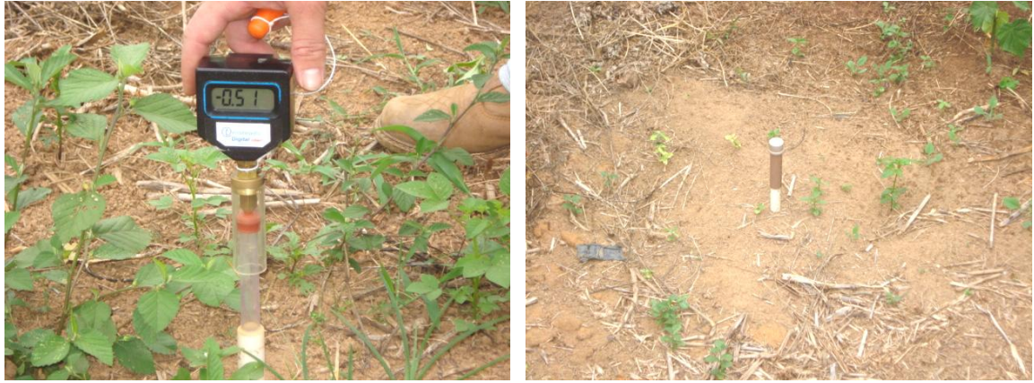
Figura 9. Leitura e locação dos tensiômetros digitais na área experimental.
