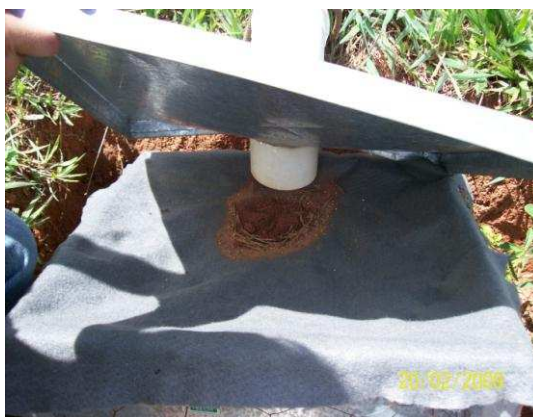
Figura 2. Caixa coletora de sedimento e manta com sedimento coletado na parcela experimental.
