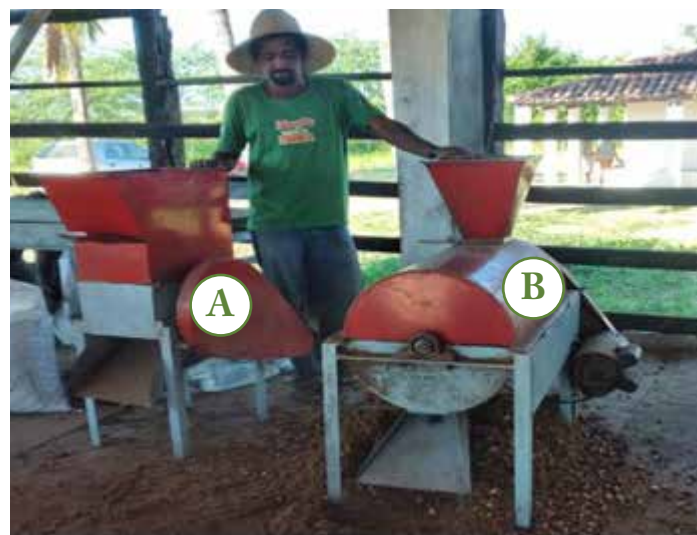
Figura. 01. (A) – Máquina quebradeira de licuri; (B) – Máquina despeladeira. Fonte. Acervo do próprio pesquisador
