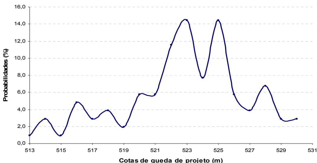
Figura 10 – Freqüência das quedas de projetos da barragem Manoel Novaes.
