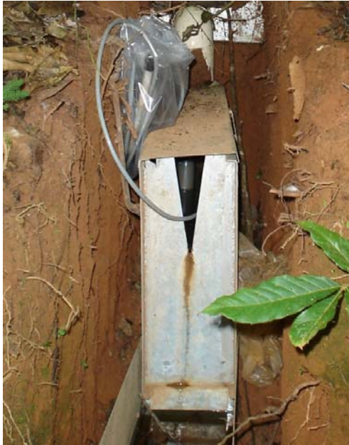
Figura 11 - Medição de escoamento das parcelas, através de linígrafo instalado no vertedouro.
