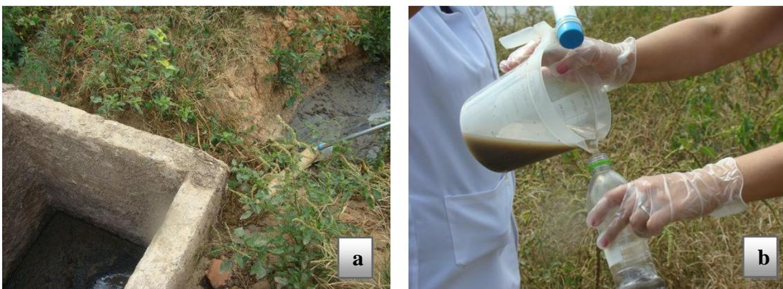
Figura 8. Vista da caixa de entrada da lagoa anaeróbia (a); transferência da amostra coletada para o frasco (b).
