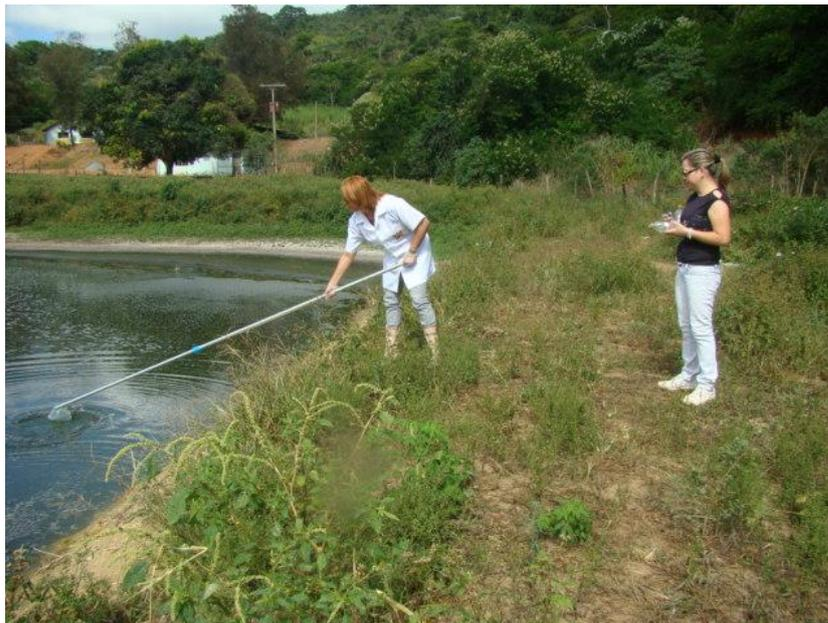
Figura 11. Vista da amostragem na lagoa de maturação pertencente à granja B.
