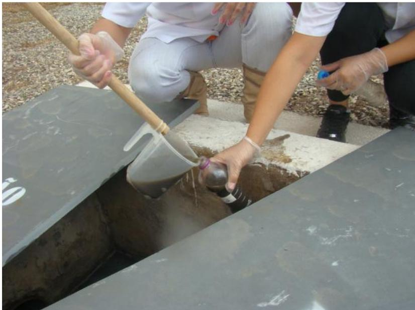
Figura 7. Coleta da amostra do efluente na caixa de saída dos biodigestores.
