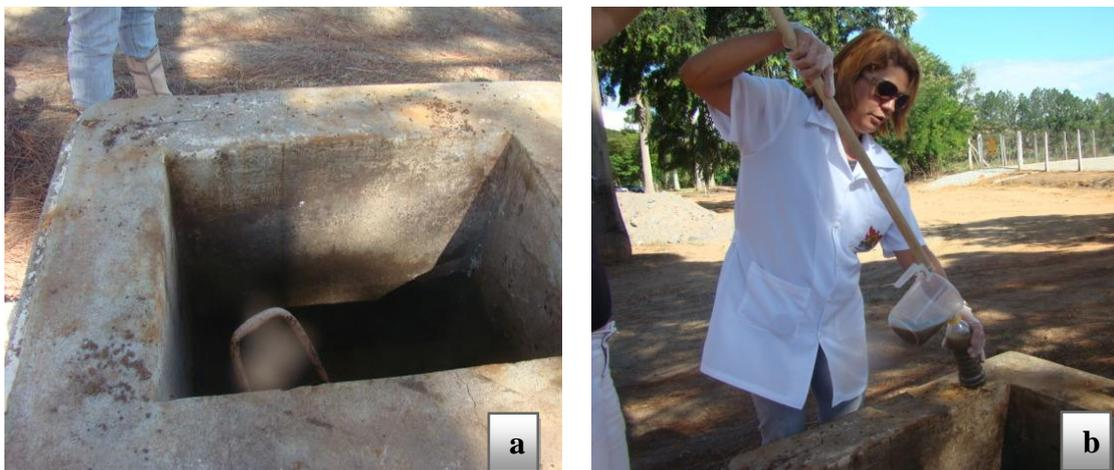
Figura 6. Caixa onde eram reunidos os efluentes dos galpões da granja "A" (a); coleta da amostra do afluente dos biodigestores (b).
