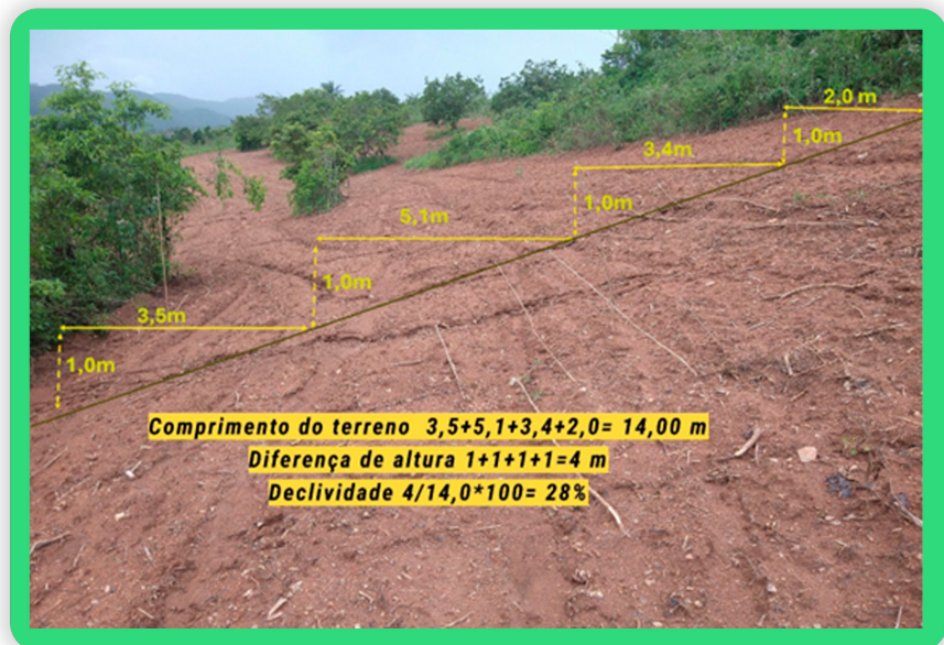
Figura 18 – Demostración de cálculo de declividad. Caruaru, 2023.
