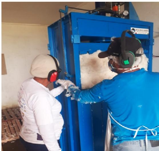
**Figura 14:** Enfardamento da pluma do algodão utilizando a prensa.
