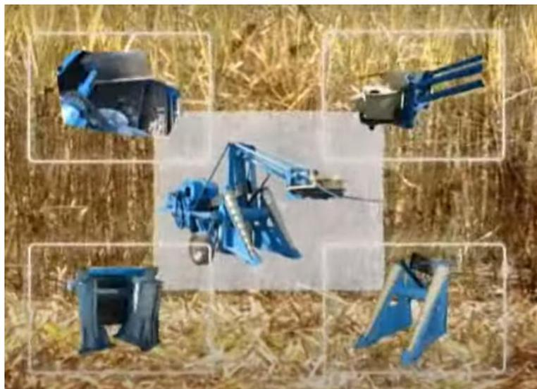
A Cañera INTA trabalha junto a um trator de 80 HP e possui uma barra transversal adaptada ao veículo e empurrada pela lateral; conta com um despontador do extremo ou broto das canas, um sistema por meio do qual é feito o corte da base da cana inteira, que imediatamente passa por um conjunto de rolos e escovas que a despalha, para finalmente expulsá-la a uma carreta basculante.
