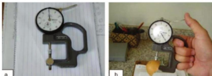
**Figura 2** – Micrômetro (a) de precisão para mensurar a espessura da casca (b).
