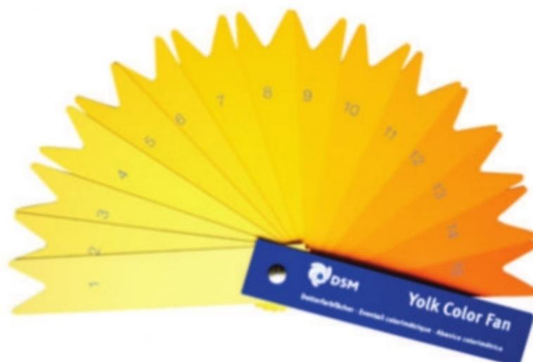
**Figura 11** – Método subjetivo de avaliação da cor da gema (Leque colorimétrico da DSM Nutritional Products<sup>®</sup>).
