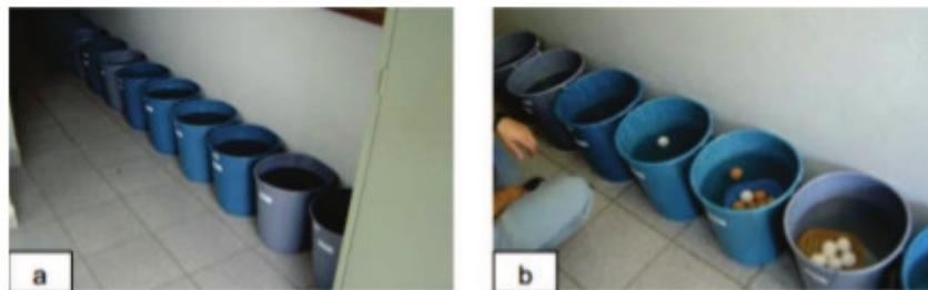
**Figura 3** – (a) Recipientes com as soluções salinas; (b) A avaliação do peso específico por imersão nas respectivas soluções.
