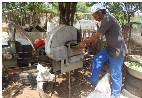
Foto: Máquina de cortar palma, criada por Ito
